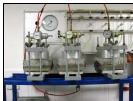
Abb. 3 Prüfaufbau für Innenabdichtungssysteme
